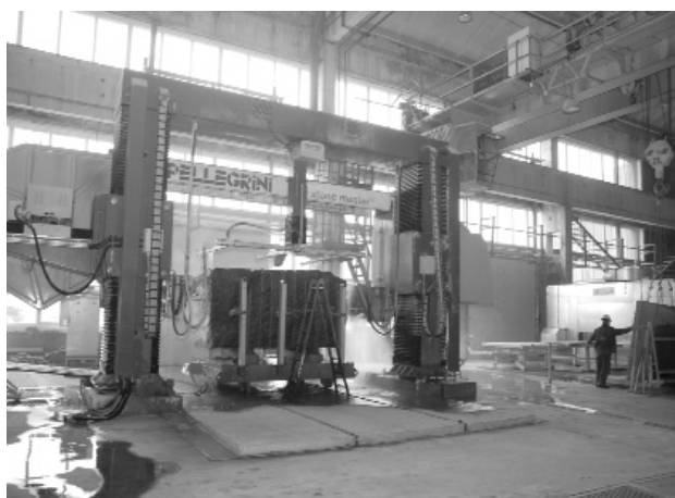
Рис. 1. Алмазно-канатная распиловочная машина на производстве ООО "АКАМ"
